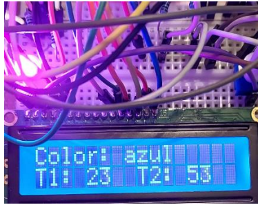
Estado “Dispositivo programado” Led en color fucsia y los dos temporizadores en marcha
