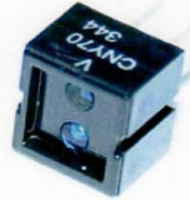
El sensor tiene cuatro pines de conexión. Dos de ellos se corresponden con el ánodo y cátodo del emisor, y las otras dos para el colector y el emisor del receptor.
