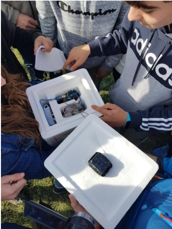
Ensamblaje de la batería, el calentador y los sistemas electrónicos en la caja de carga útil antes del lanzamiento.
